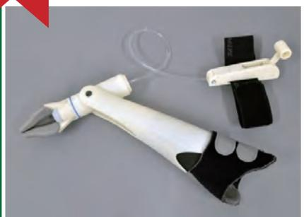
前腕欠損者のための義手として、電動義手の開発が多数行われてきました。しかし、電動義手は電動アクチュエータ、バッテリーなどが必要になるため重量が重い、水回りの作業に向かない、駆動音に課題があります。これらの課題を解決するために、電動義手 Finch をベースにシリンジ2本を組み合わせた水圧アクチュエータを用いた3指義手を開発しました。
