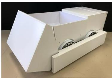
介助者の負担の軽減を目的とし、ボールを回収するロボットを製作しました。回収のメカニズムとして回転ブラシを採用する事で硬さや表面素材にばらつきのあるポッチャボールへの対応を可能としました。また操作は、Joystick型コントローラーを採用する事で誰でも簡単に操作できることで、ボール回収の場面での負担軽減に貢献できると考えます。
