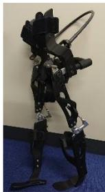
脊髄損傷などのこどものためのリハビリテーションツールとして、長下肢装具が用いられます。開発装具の骨格部分は樹脂素材の積層によって造形するため、軽量且つ、成長に応じた作り替えが可能であり、骨格としての剛性・耐久性も充分なものとなりました。左右の股関節ジョイントをワイヤーで繋ぐ交互機構を備えることでスムーズな歩行動作を実現することができます。
