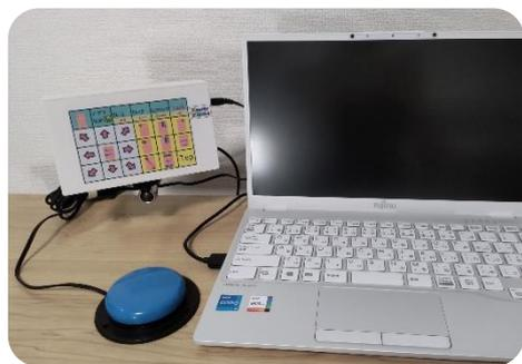
本作品は、PCやスマートフォンなどのマウス機能を1つのスイッチで操作可能にするICT機器です。接続方法は、PC等にUSBケーブルで接続し、HeartyHID24 Mouse本体に任意の操作スイッチを接続するだけです。USBで接続するだけで、デバイスの機種やOSを問わず同様の操作が可能で、制度の谷間により必要な支援が受けられない方でも安価に購入可能なワンスイッチで操作可能なマウス入力デバイスとして開発しました。
