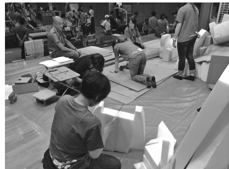
ウレタンフォームや強化段ボールを使い姿勢保持具を制作するワークショップ
