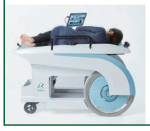
身体を動かすことができないユーザー自らが操作して動かすことができる移動機器の開発である。ユーザーの希望により、ショッピングモール内店舗を自由に動くことを目標としている。コンセプトは、WEBカメラの映像をディスプレイ表示し、映像を見ながら SMA 患者の運動障害に対応した操作デバイスを使用してストレッチャーを操作することである。
