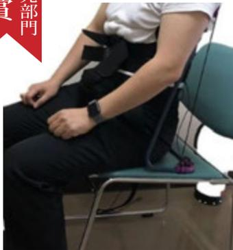
腰を浮かせる腰痛軽減装具：“フワット”（Floating WAiT：FWAT）は、ユーザの上半身の重量を、骨盤ではなく座面に伝えることで、骨盤にかかる重量を軽減する装具である。装着したユーザが着座している際の骨盤への荷重が半分に軽減される。また、ユーザは、立位時や歩行時などの着座していない状態においては、腰痛軽減装具：“フワット”を装着したまま、任意の場所に移動できる。また、移動後に任意の座面に座った場合にも、同様の効果が得られる。
