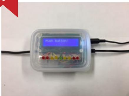
この装置はLEDと音によって指示されるタイミングに合わせてスイッチを操作し、指示されるタイミングとスイッチが反応した時間の差でスイッチと使用者の適合度を調べ、その結果を画面に表示するものである。適合度は指示されたタイミングとスイッチが反応した時間の差の平均と標準偏差で示される。
