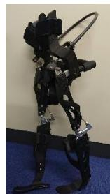
脊髄損傷などの子どものためのリハビリテーションツールとして、長下肢装具が用いられます。開発装具の骨格部分は樹脂素材の積層によって造形するため、軽量且つ、成長に応じた作り替えが可能であり、骨格としての剛性・耐久性も充分なものとなりました。左右の股関節ジョイントをワイヤーで繋ぐ交互機構を備えることでスムーズな歩行動作を実現することができます。
