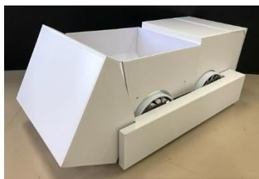
介助者の負担の軽減を目的とし、ボールを回収するロボットを製作しました。回収のメカニズムとして回転ブラシを採用する事で硬さや表面素材にばらつきのあるボッチャボールへの対応を可能としました。また操作は、Joystick型コントローラーを採用する事で誰でも簡単に操作できることで、ボール回収の場面での負担軽減に貢献できると考えます。
