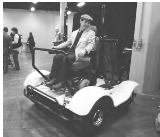
図2 電動車いすの動力を利用して走行するオフロード用カート
